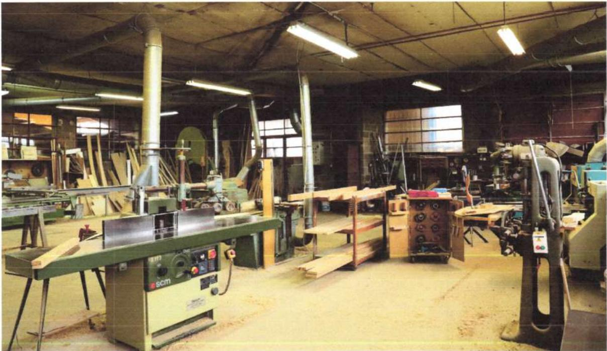
Complété d'un atelier de stockage de 300 m<sup>2</sup> et d'une salle de vernis de 60 m<sup>2</sup>, l'atelier comprend un panel de machines traditionnelles en fonte capables de fabriquer sur-mesure créations unitaires et petites séries : dégauchisseuse, scies à format et à ruban, 2 toupies pour confectionner des fers, tenonneuse à dérouleur, 2 mortaiseuses, ponceuse longue bande et corroyeuse 4 faces.
