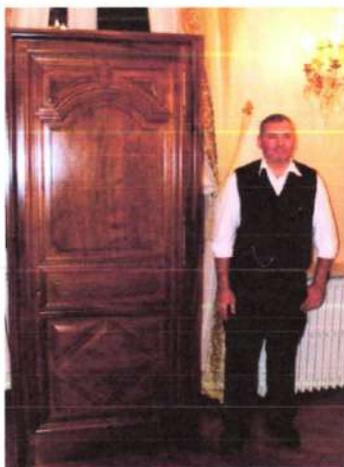
Elle comporte une traverse haute cintrée avec 2 petits panneaux pointe de diamant à 3 pointes. Elle a été assemblée selon la technique du flottage avec une moulure en coupe d'onglet en parement et un arasement arrière droit.
